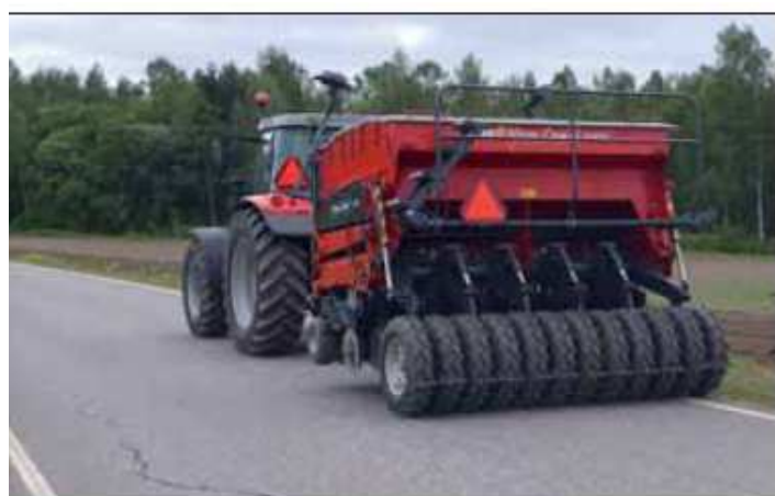
Szerokość transportowa Nova Combi 3000 to tylko 3 m
