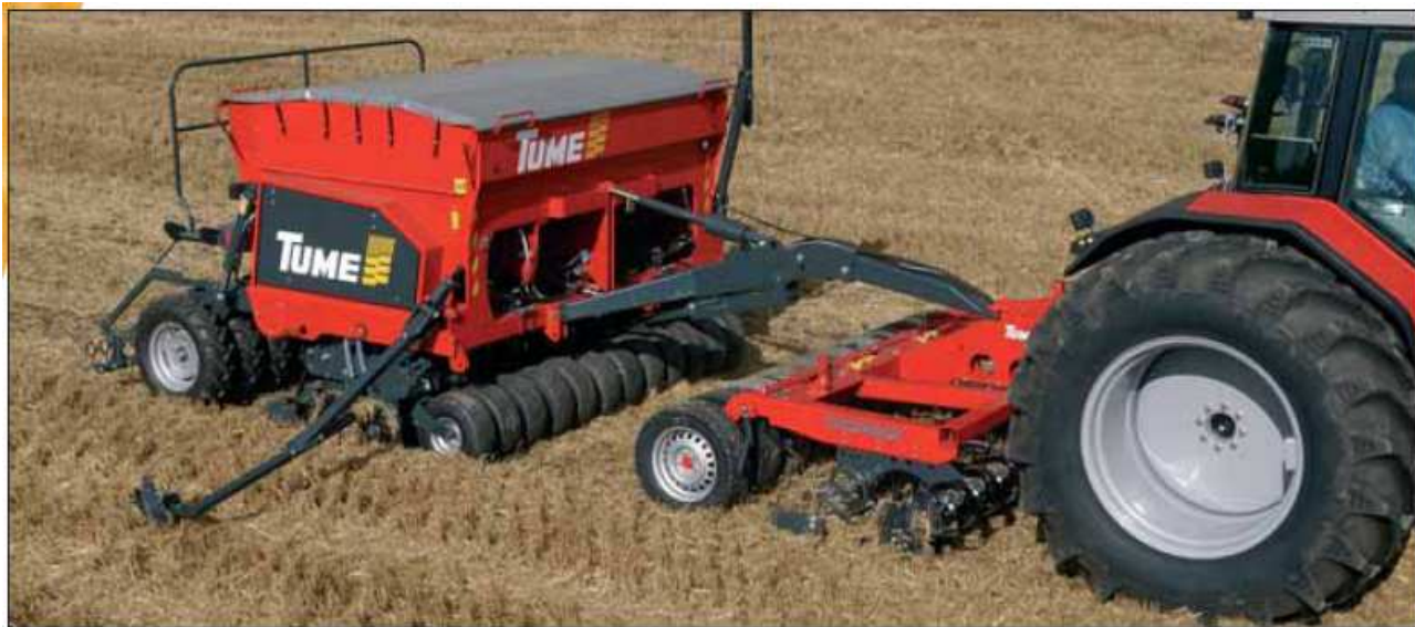
Dyszel może być zamocowany w pozycji górnej dla zastosowań takich jak kombinacja CultiPack.
