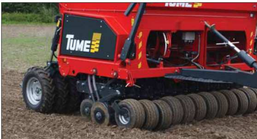
Nova Combi zawiera solidny zestaw kół oraz wysoce adaptacyjny zestaw redlic
